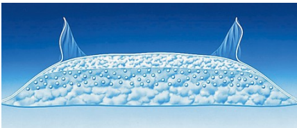
Dreiteiliger Saugkörper aus Grundmatte, Superabsorber-Schicht und Dry-Plus-Vlies.
